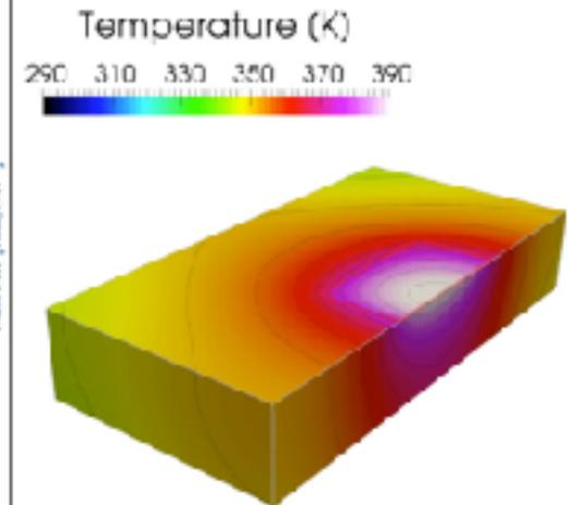
Temperatur und Stromfluss in großflächiger OLED
